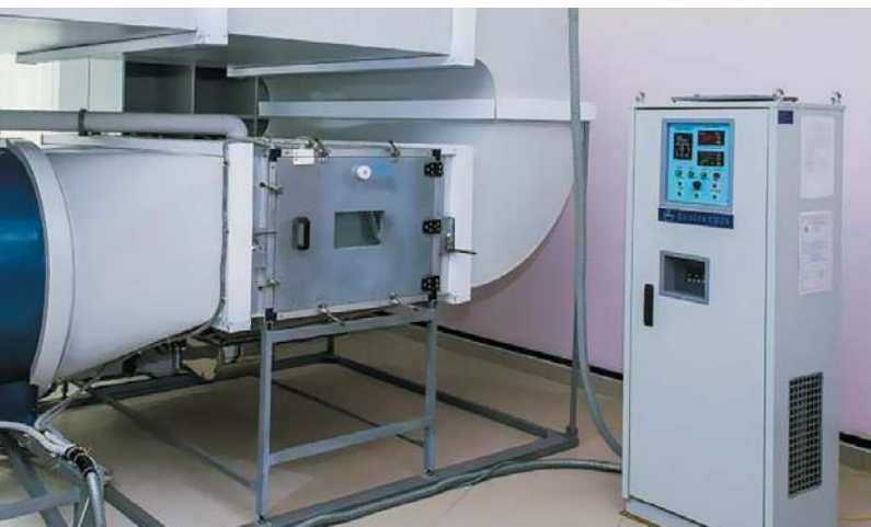
Рис. 2. Камера пыли КП-2,0
